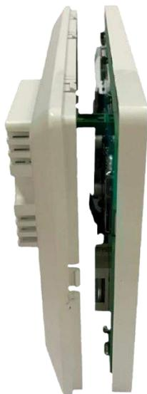
Рис. 23.: Шаг 2. Разъединение панелей дисплея
