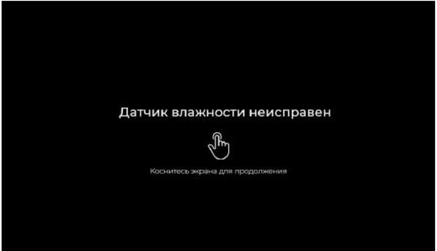
Рис. 44. Ошибка неисправности датчика влажности.
